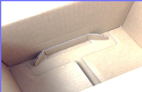
「纸箱组装完成后，内部形成锁扣」 要取出产品必须破坏纸箱结构
